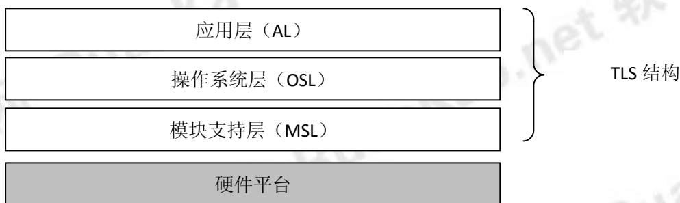
图 3-1 宇航嵌入式设备软件架构
